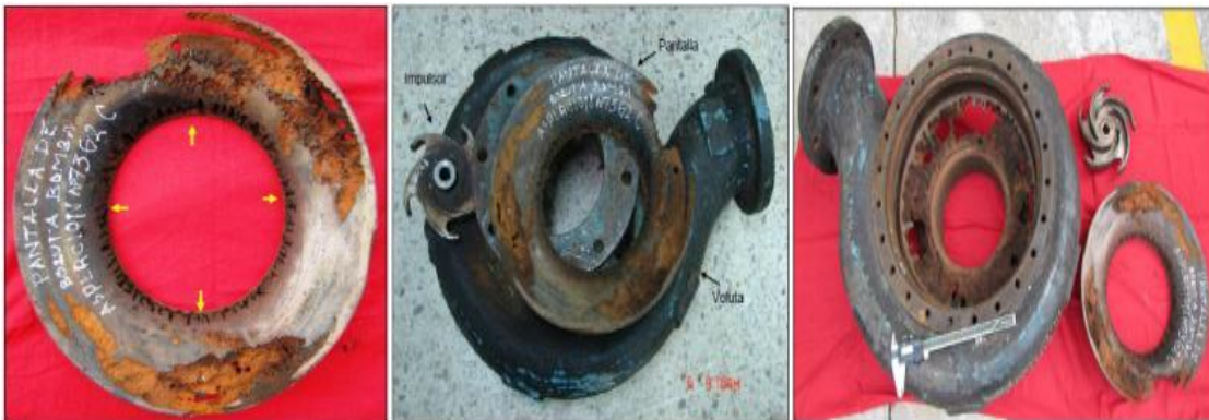
Figura 28. Corrosión en bombas centrífugas de las piscinas de aspersión.
