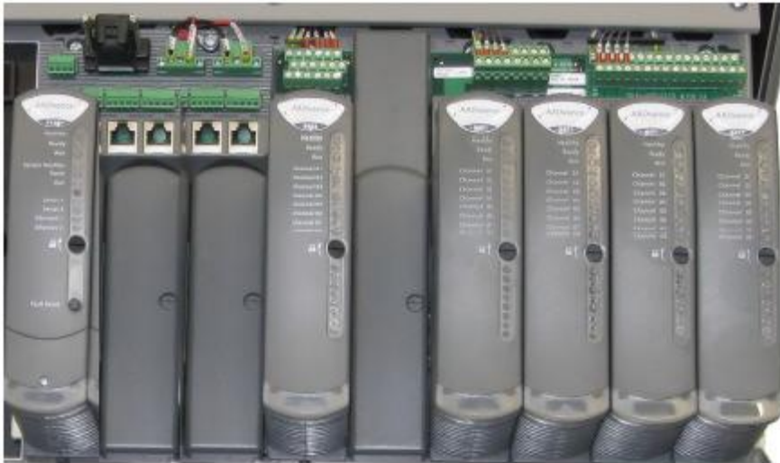
Figura 14. Arquitectura de Logic Solver tipo 1
