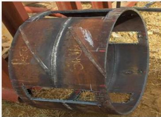
Figura 7 Cortes de probetas para ensayos mecánicos
