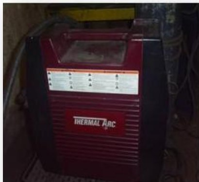
Figura 9 Equipo de soldadura SMAW
