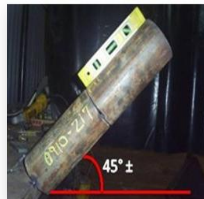
Figura 18 Posición de soldadura a 45°
