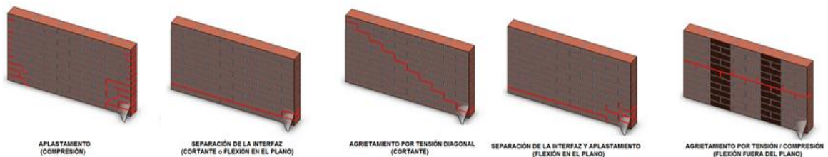
Figura 20. Fallas típicas de los sistemas muro-FRP más su deslaminación.
