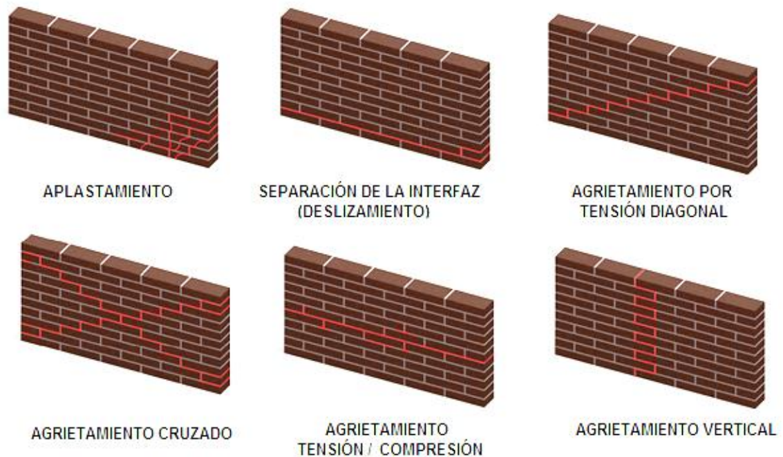
Figura 2. Fallas típicas de la mampostería simple.
