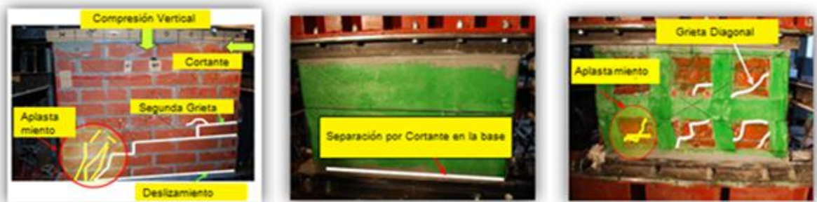
Figura 18. Tipo de Falla de los modelos experimentales.
