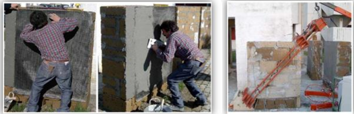
Figura 7. Colocación externa del refuerzo CFRP (izquierda) y modelo de la prueba a compresión diagonal (derecha).
