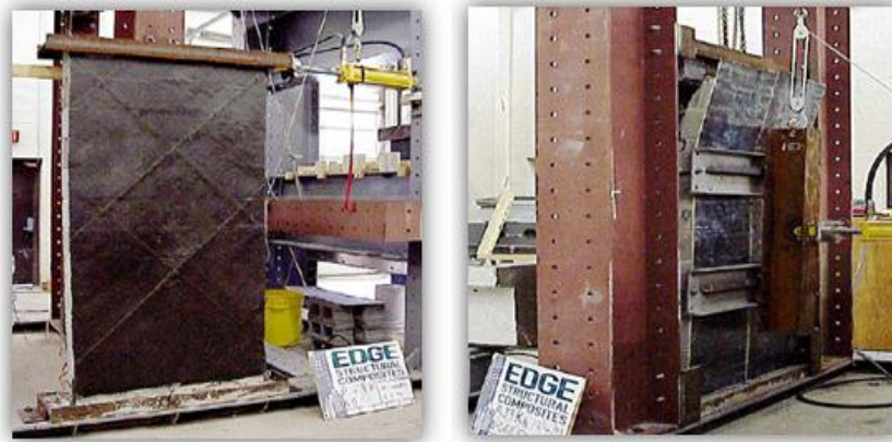
Figura 6. Pruebas en muros con CFRP: de cortante por cargas laterales (izquierda) y flexión fuera del plano (derecha).
