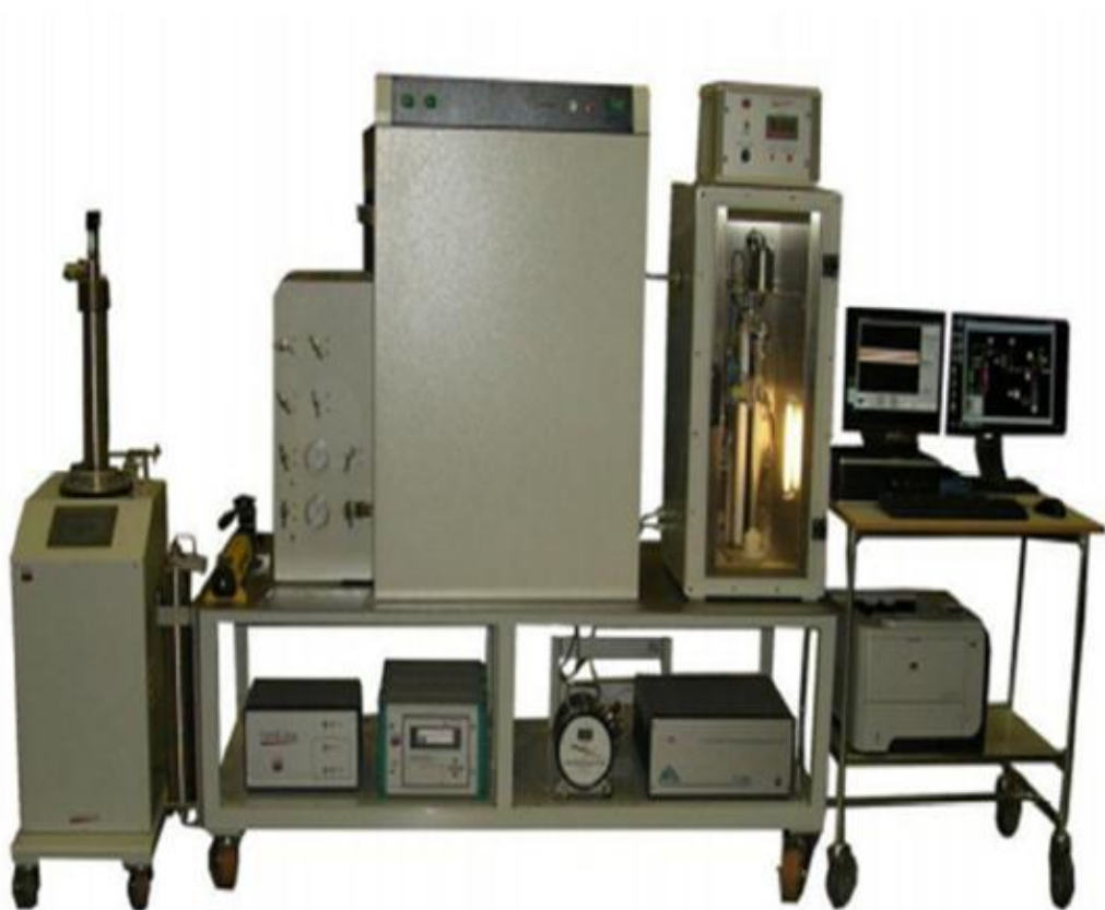
Figura 7. Aparato Slim – Tube para medir la presión de miscibilidad.
