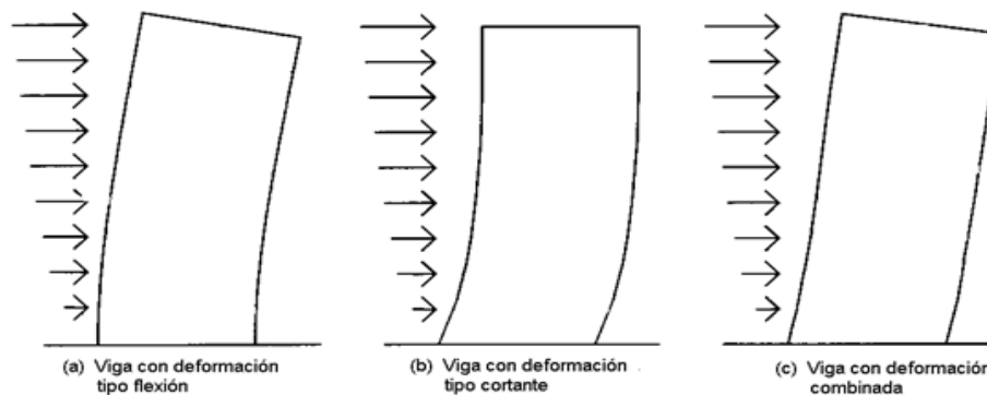
Figura 2. Vigas con diferente tipo de deformación lateral
