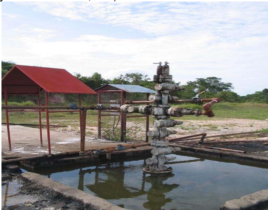
Figura 32. Pozo en Gas Lift , Sarta paralela. La Salina B10.
