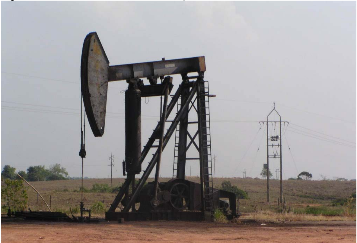
Figura 5. Unidad de Bombeo Balanceada por Aire.
