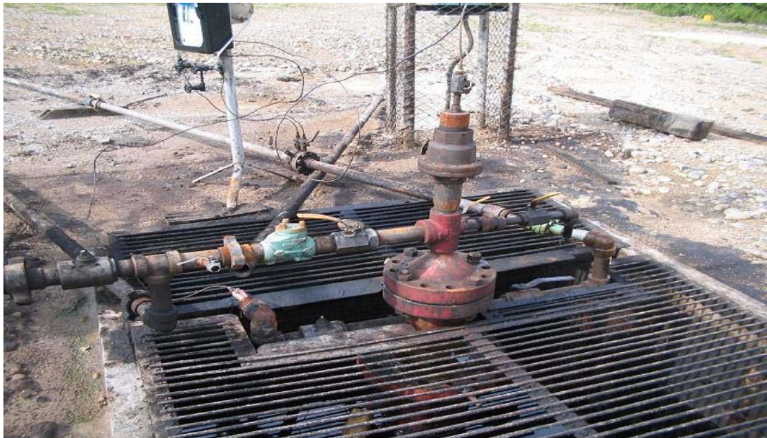
Figura 31. Pozo en Gas Lift Sencillo con empaque, inyección de gas por anular. La Salina M14.
