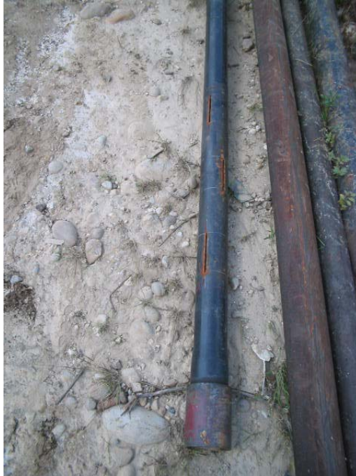
Figura 54. Ancla de gas de 3-1/2" de Diámetro Externo.
