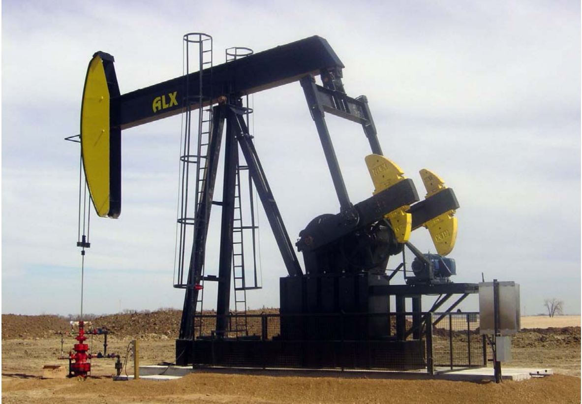
Figura 3. Unidad de Bombeo Convencional.
