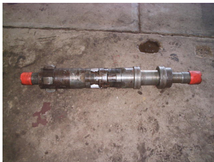
Figura 74. Empaque A-2 Lockset utilizado en el sistema de fondo. Payoa 3.
