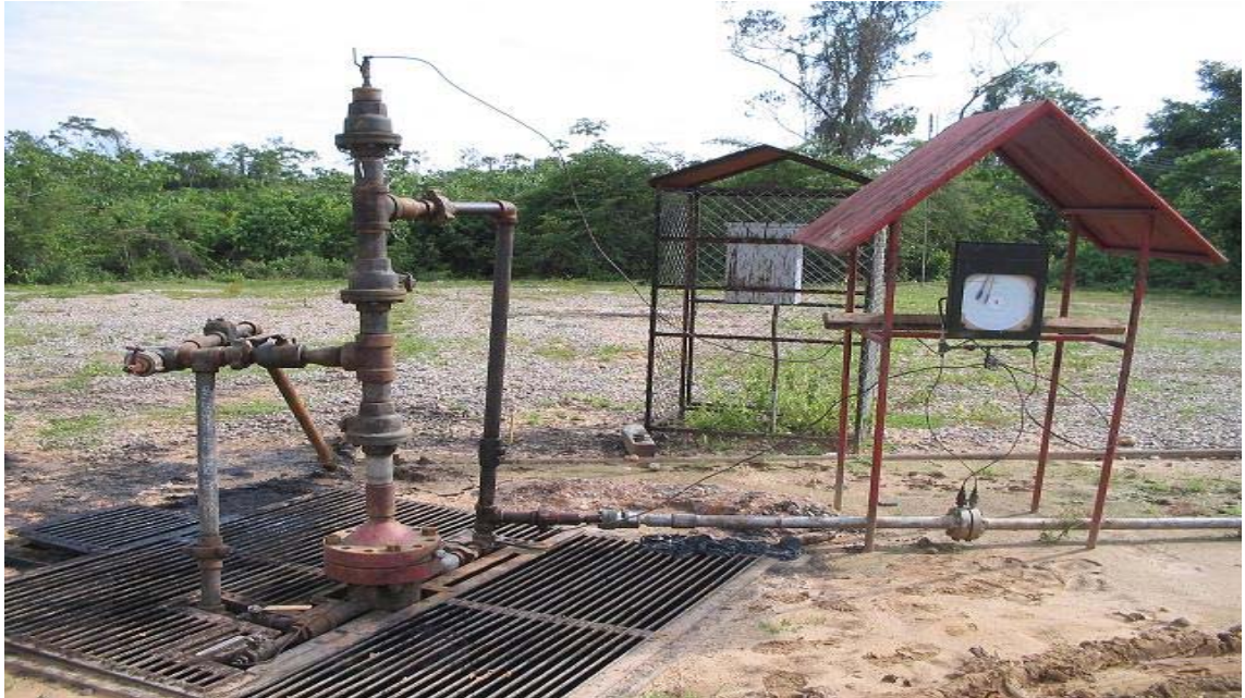
Figura 30. Pozo en Gas Lift, inyección de gas por tubing , producción por anular. La Salina M15.
