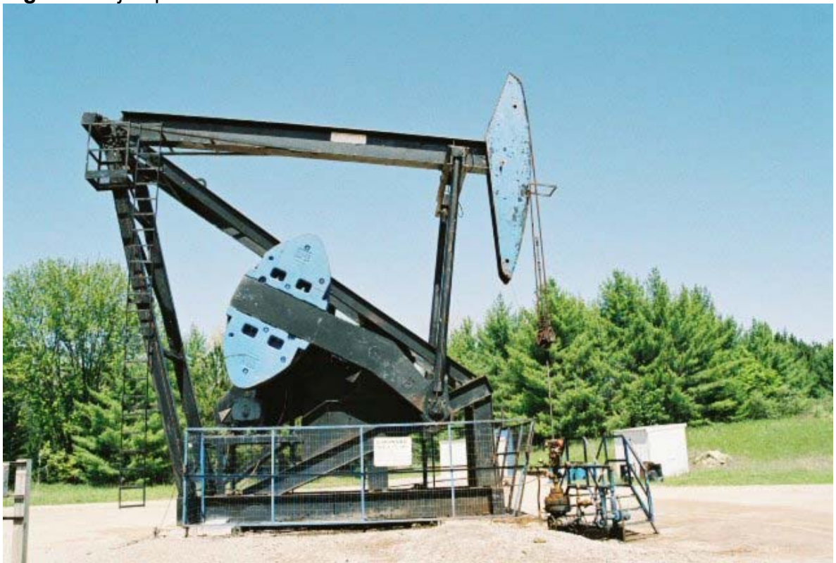
Figura 7. Ejemplo de Unidad de Bombeo Mark II .
