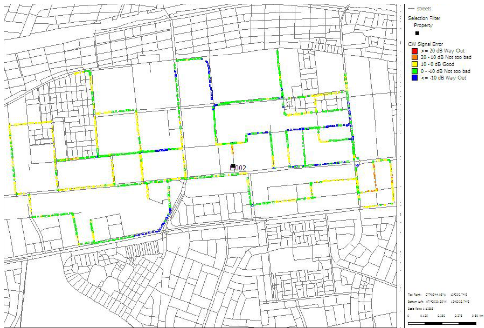
Figura No. 6.18. Niveles de error alcanzados en la ruta Industrial con el Modelo Hata Cost 231 ajustado Lima 1900.
