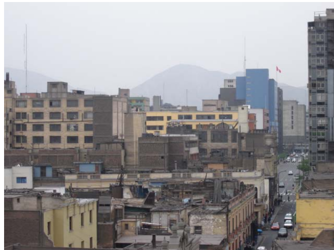
Fotografía No. 2 Zona centro de la ciudad de Lima, clasificado como clutter tipo denso urbano.
