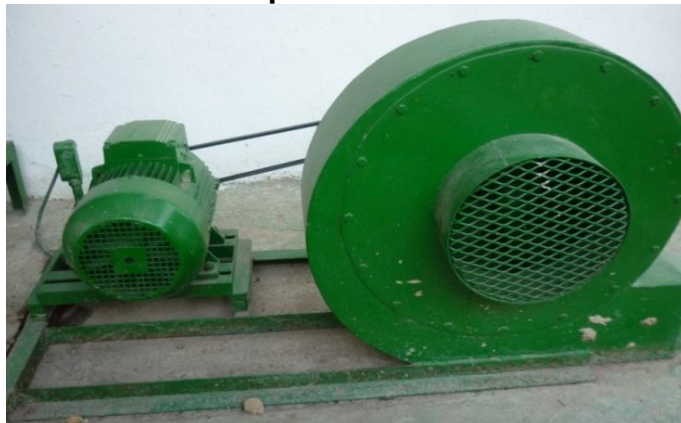
Figura 37. Sistema de aireación para camellones.
