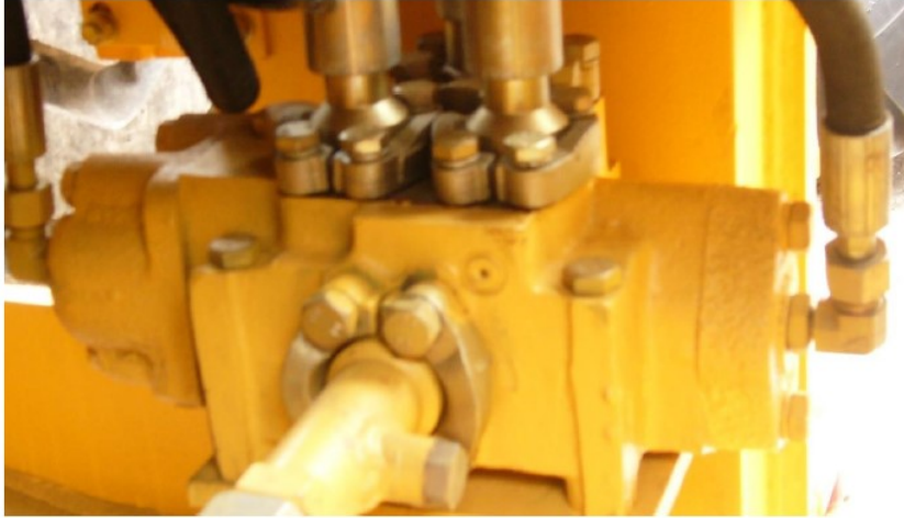
Fotografía 2. Válvula amplificadora de flujo. Fuente: CLG842II/856II/862II. ENTRENAMIENTO INTERNACIONAL. Liu Gong. 2012
