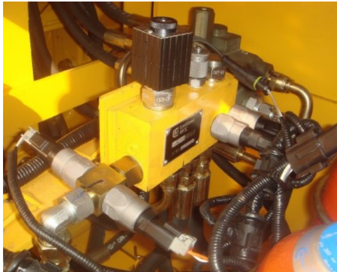
Fotografía 3. Válvula de freno de estacionamiento. CLG842II/856II/862II. ENTRENAMIENTO INTERNACIONAL. Liu Gong. 2012
