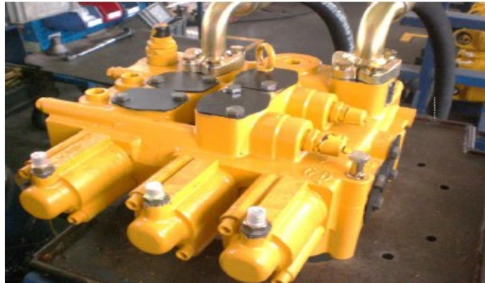
Fotografía 1. Válvula principal de trabajo. CLG842II/856II/862II. ENTRENAMIENTO INTERNACIONAL. Liu Gong. 2012
