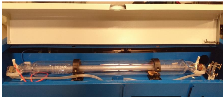
Figura 58. Láser de dióxido de carbono instalado.
