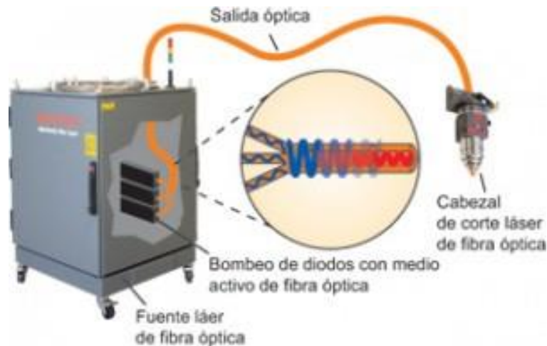
Figura 3. Esquema principal de un láser de fibra óptica.
