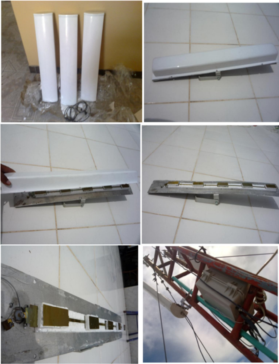
Imagen 231 Interior de las Antenas a utilizar
