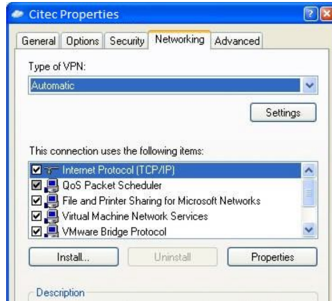
Imagen 126 edición de propiedades de protocolo TCP/ip para cliente VPN
