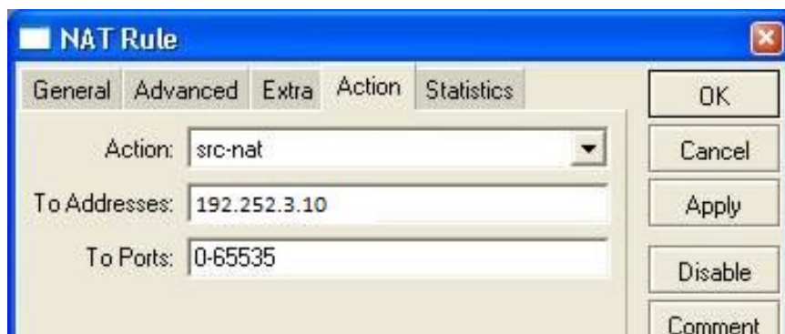
Imagen 157 Acción para la segunda regla NAT de salida por proveedor
