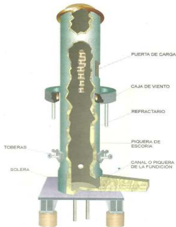
Figura 1. Horno de Cubilote
