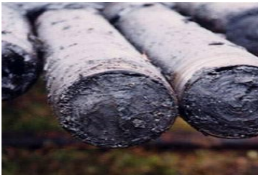
Figura 8. Taponamiento de tubería de extracción de crudo
