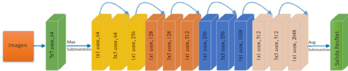
Figura. 17. Arquitectura de la red convolucional residual ResNet para la estabilización del gradiente, adaptado de Talo (2019).
