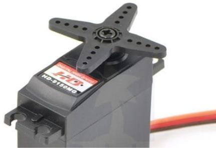
*Figura. 27.* Servomotor
