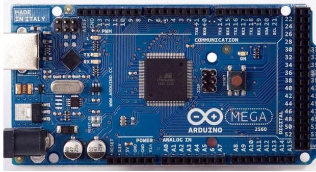
Figura. 30. Placa Arduino Uno/Mega, utilizada para aplicaciones de adquisición, tratamiento y transmisión de señales digitales y analógicas.
