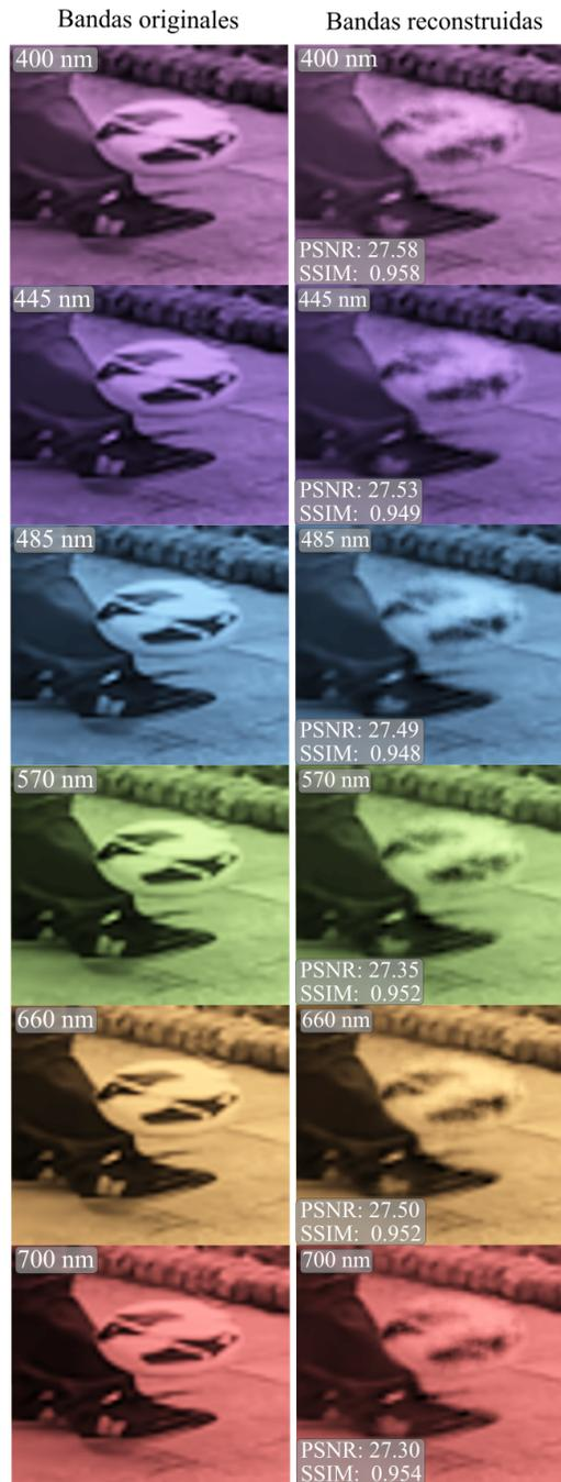
Figura. 49. Resultados espectrales del SV con la escena de un balón de fútbol en la que se observan 6 bandas espectrales para la escena original y la reconstrucción. Se incluyen las métricas de PSNR y SSIM con las longitudes de onda de cada banda correspondiente.
