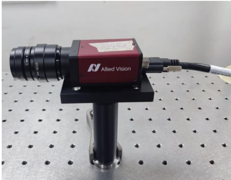
*Figura. 25.* Montaje de sincronización Computador, y Cámara F-080B, mediante conexion USB
