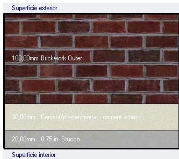
Figura 45. Materiales que componen la estructura de las paredes
