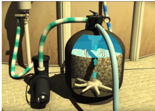
Figura 17. Operación del filtrado de una piscina
