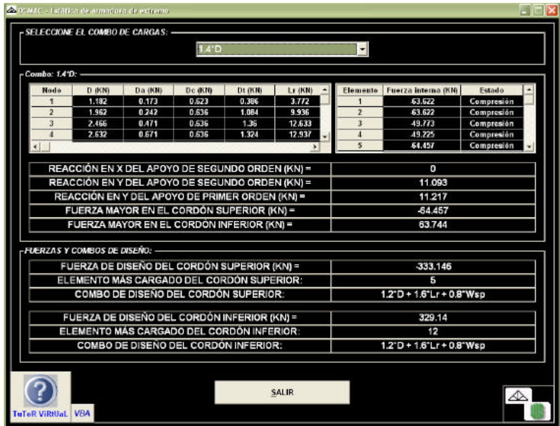
Figura 39. Módulo Estática de armadura de extremo
