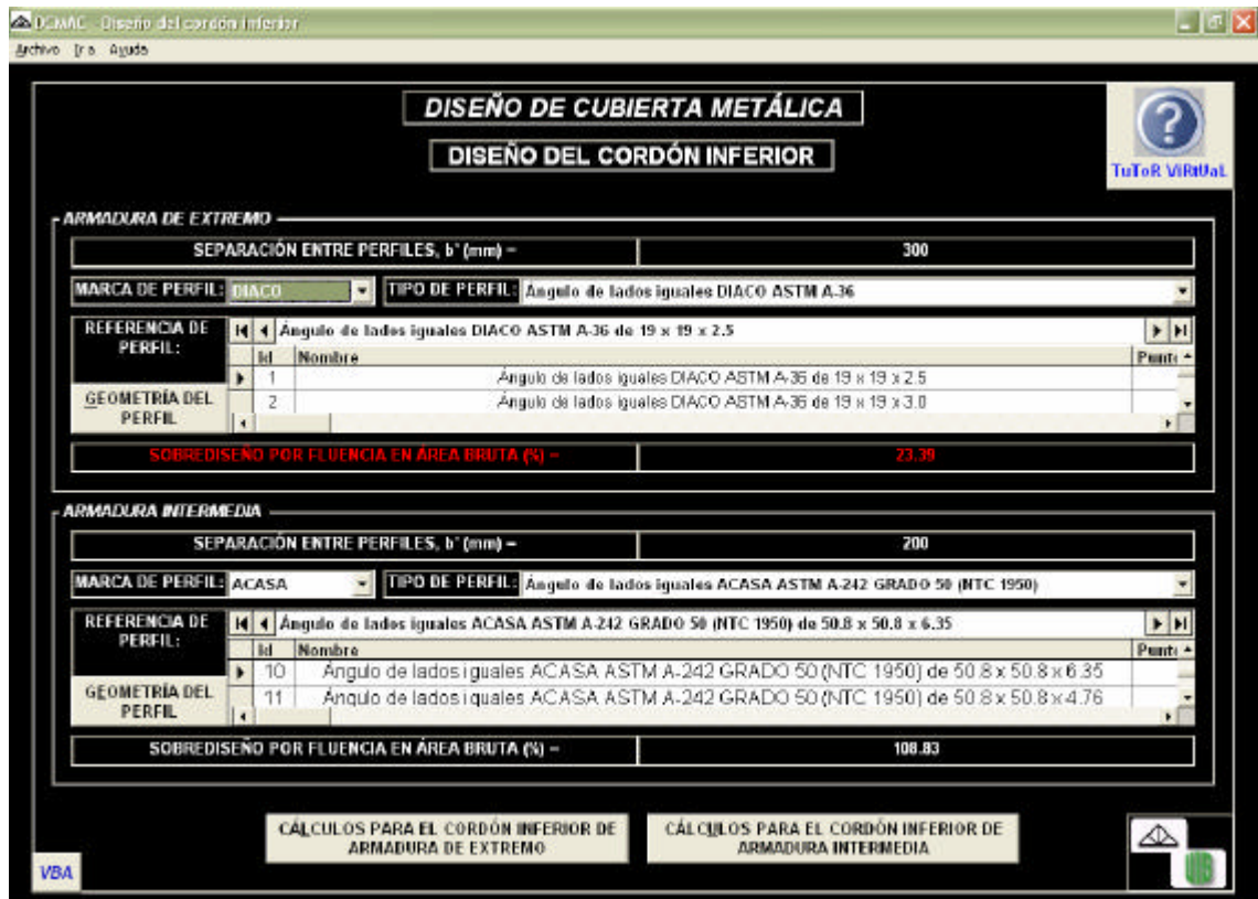
Figura 48. Módulo del cordón inferior (2)
