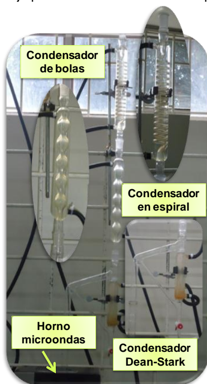
Figura 20. Montaje para hidrodestilación asistida por microondas.
