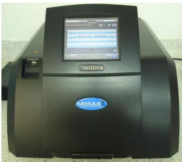
Figura 23. Lector de microplacas Turner Biosystems Inc., Modulus™ II Microplate Multimode Reader (Sunnyvale, CA, EE.UU.), con microplacas de poli(estireno) de 96 pozos y equipado con módulos de absorbancia (UV-Vis) y fluorescencia.
