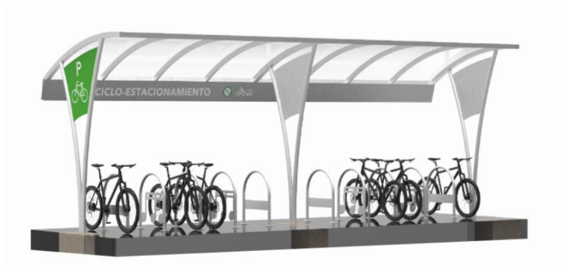
Figura 33. Visualización 3D Ciclo-estacionamiento Cubierta Doble. Adoptado de Dirección de Tránsito de Bucaramanga - Oficina de la Bicicleta (2017). Guía Técnica para la implementación de ciclo-infraestructura secundaria. Bucaramanga.
