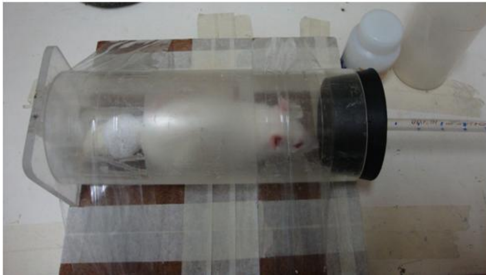
Figura 8. Cámara para registro del Consumo de Oxígeno para animales pequeños
