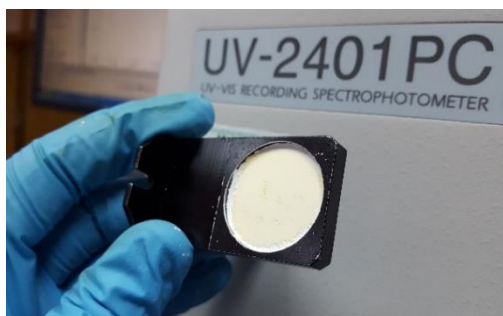
Figura 8. Portamuestra para análisis por reflectancia difusa.
