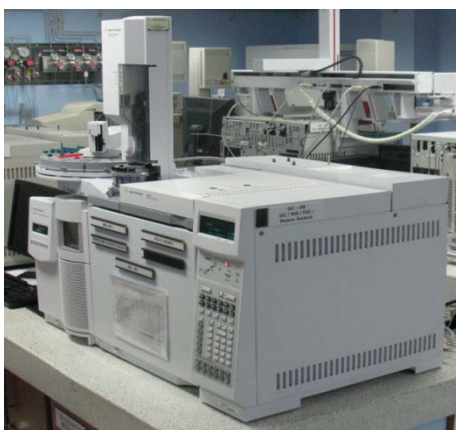
Figura 10. Cromatógrafo de gases Agilent 6890 Plus , acoplado a un detector de masas ( MSD 5973 Network ) y un inyector automático Agilent Technologies 863 Series . Fotografía tomada por el autor en el laboratorio CROM-MASS el 02-02-2011.
