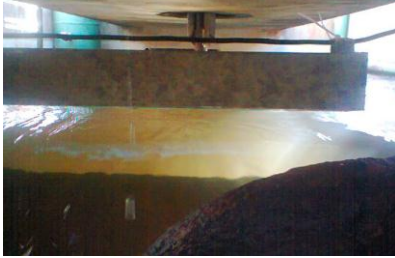
Figura 13 Montaje prototipo UV en cámara de mezcla
