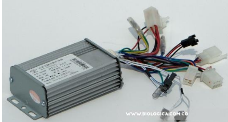
Figura 57. Controlador de 500W 48V12A
