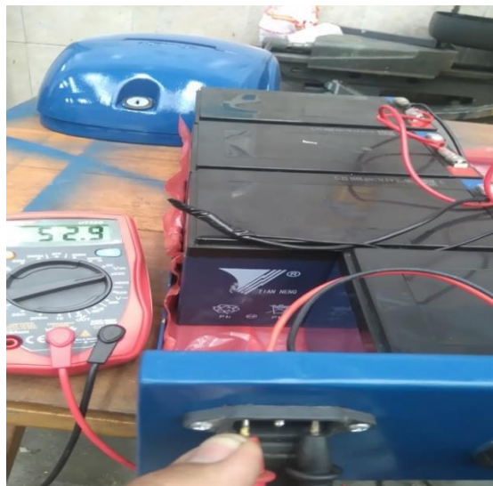
Figura 73. Prueba de voltaje
