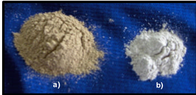
Figura 54. Fotografía del mineral LR-2 en estado natural (a) y lixiviado (b) (0.3M ácido oxálico, 80°C, 12h, 10% p/p)
