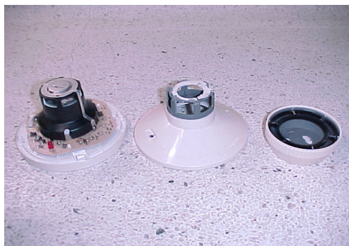
Figura 1.5 Mantenimiento del sensor iónico.
