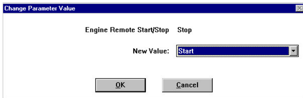
Figura 21. Encendido remoto de la planta.
