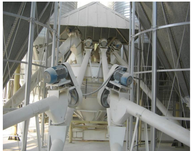
Figura 15. Transportador sin-fin de evacuación de los silos 10 al 13 de la balanza # 2
