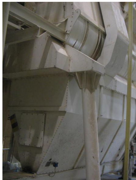
Figura 24. Características de la Mezcladora y Tolva de alivio bajo mezcladora
