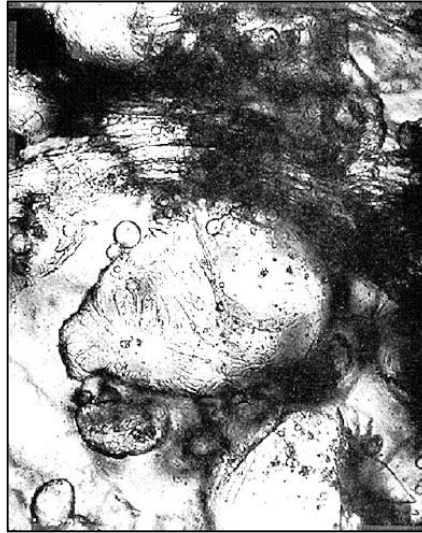
Figura 2. Microfotografía del agente emulsificante rodeando una gota de agua.
