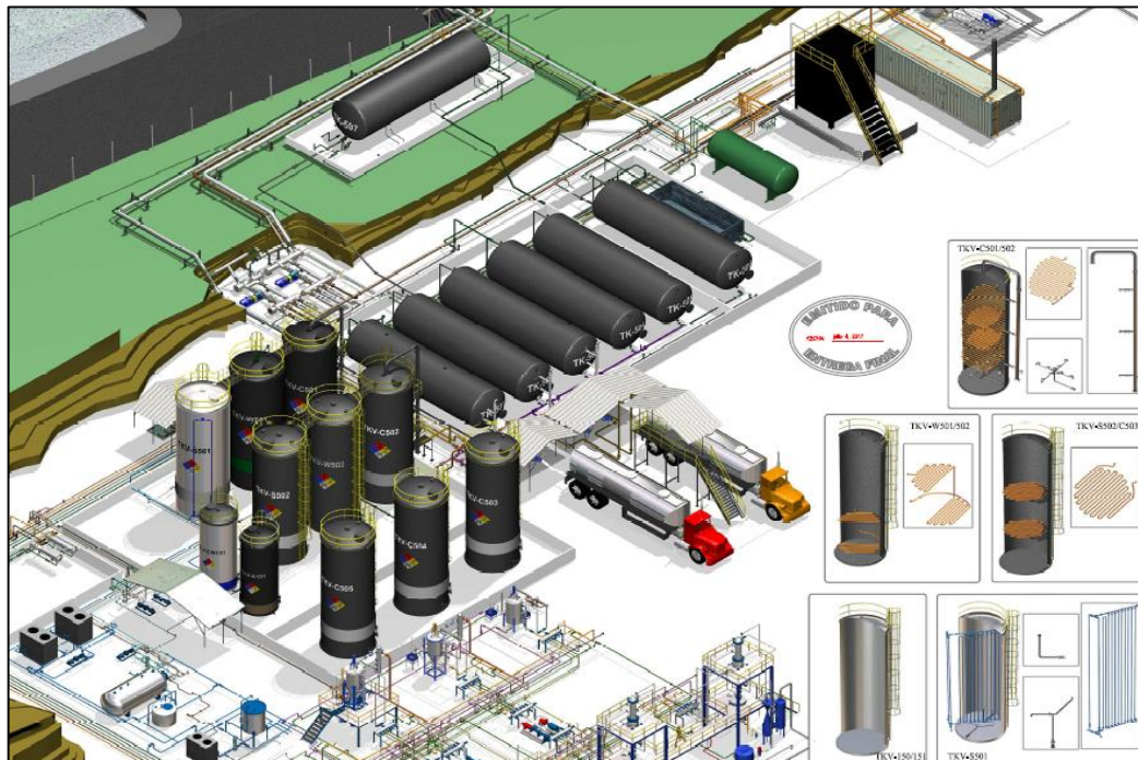
Figura 13. Capella A: zona de descarga, Tanques horizontales y verticales.
