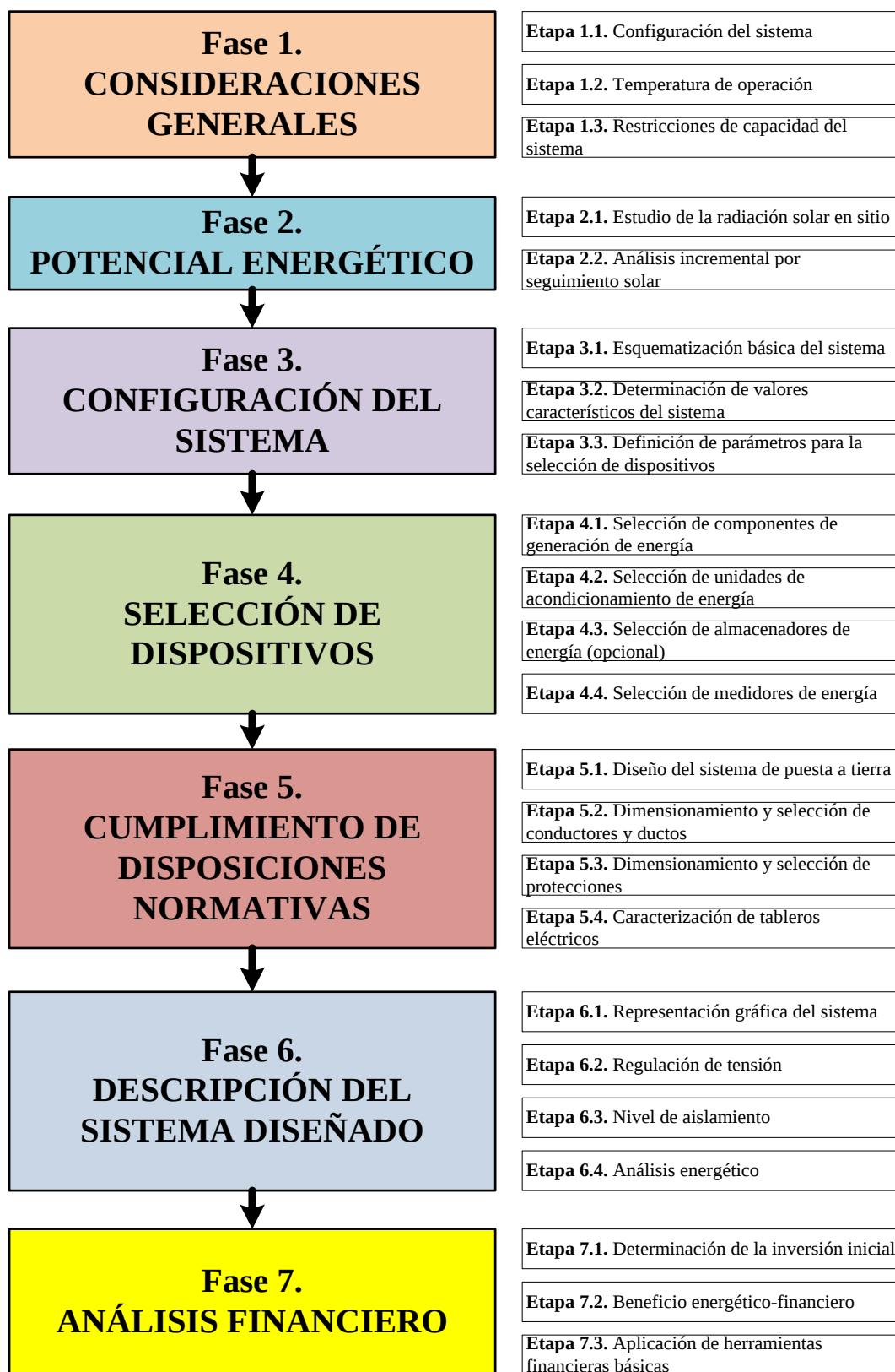
Fig. 1.3. Esquema de la metodología aplicada para el diseño del sistema fotovoltaico.
