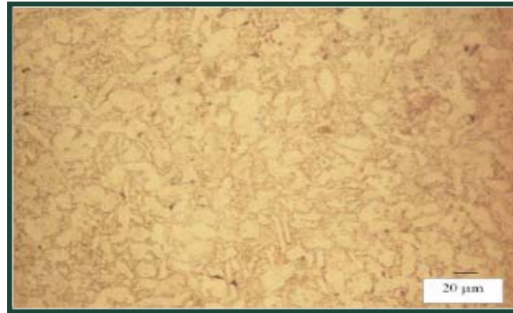
Figura 16 Micrografía de la probeta de Ti_6Al_4V .
