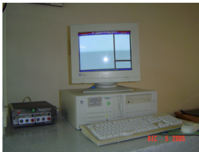
Figura 14 Equipo GALVPOT GP 201 – H y computador usado en la toma de datos.
