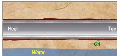
Figura 2 Efecto Talón-Punta en la sección Horizontal
