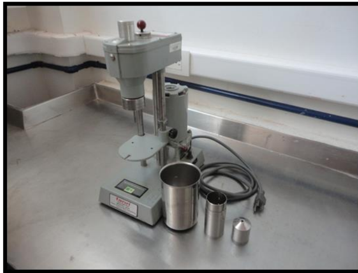
Figura 8. Viscosímetro Fann 35 A
