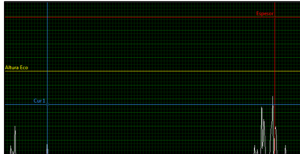
FIG 77 Muestreo de datos en presentación A-Scan
