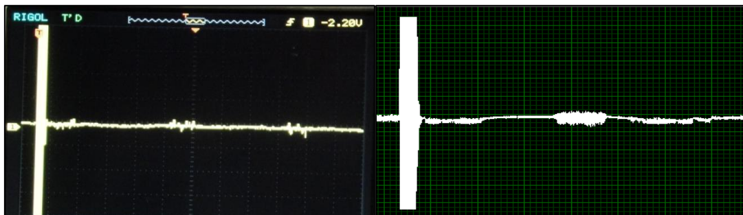
FIG 80 Ecos amplificados producido por el transductor sin contacto con la superficie.
