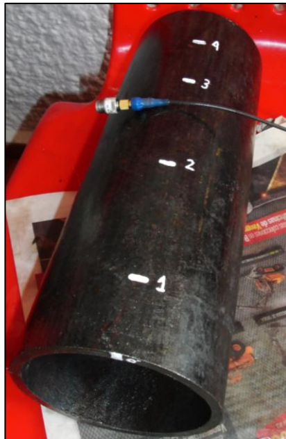
FIG 83 Anillos de inspección
