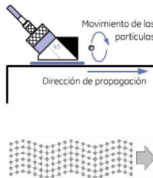
FIG 14 Generación de Ondas superficiales
