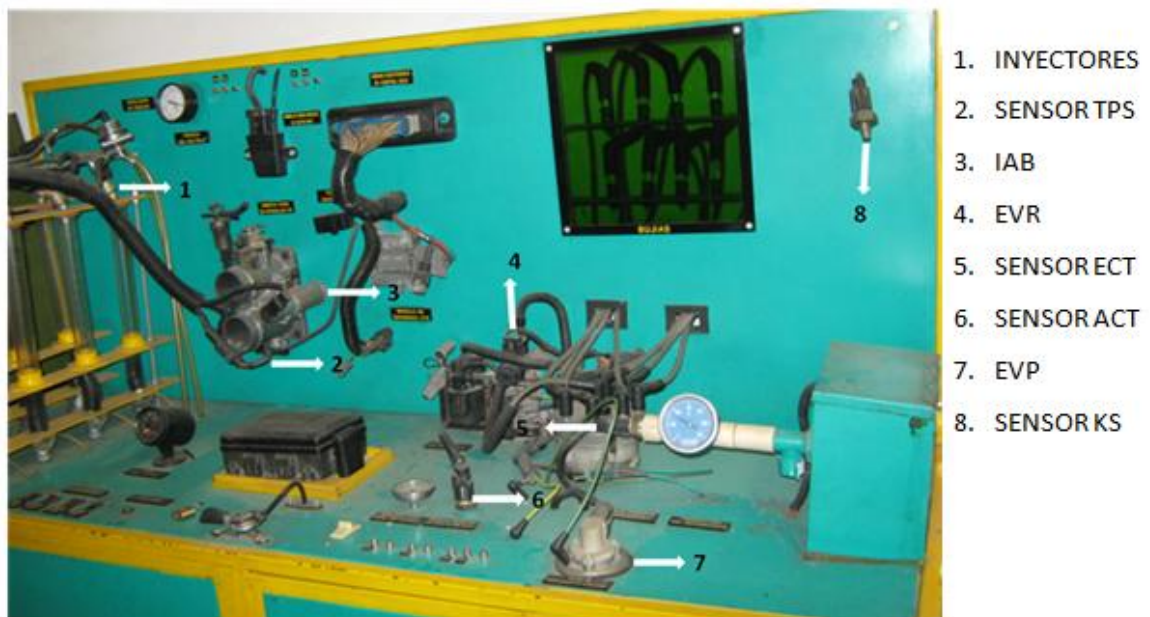
Figura 7: Ubicación del los Sensores en el Banco Preliminar
