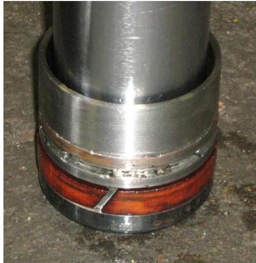
Figura 44. Anillo de detención etapa 4 montado en la etapa.
