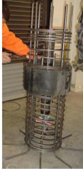
Figura 13. Cojín elastomérico como mecanismo de disipación de energía.
