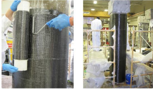
Figura 19. Chaqueta fabricada a partir de fibras reforzadas con polímeros.
