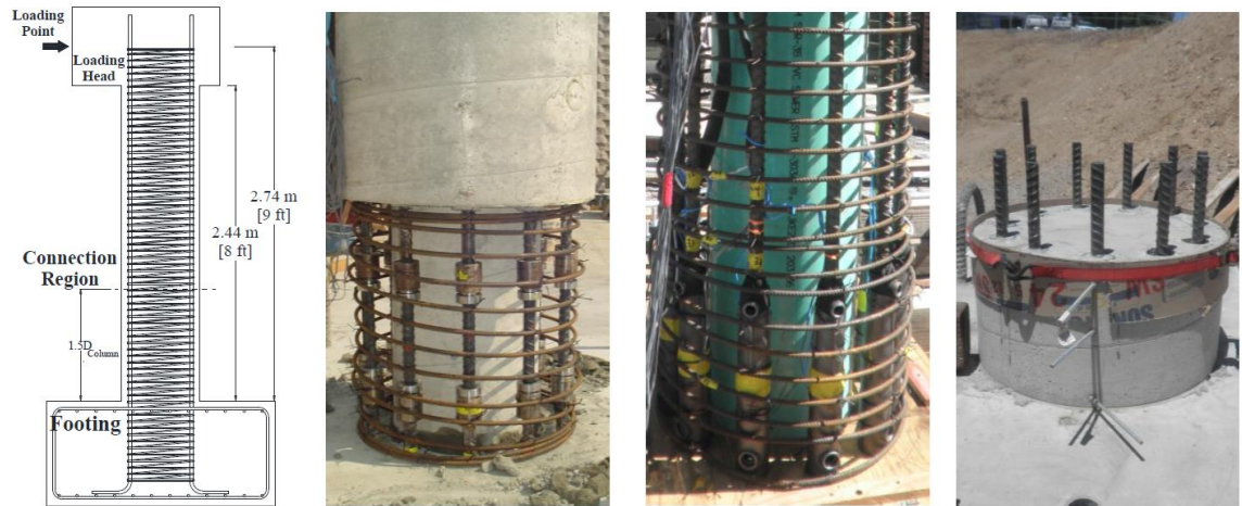
Figura A.33. Columnas representativas de prueba.
