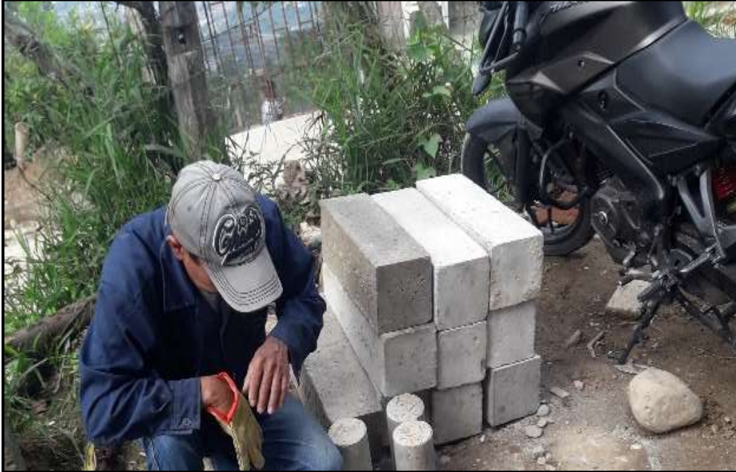
Figura 23. Vigas de ensayo concreto planta
