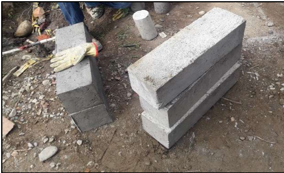
Figura 25. Vigas de ensayo concreto en sitio
