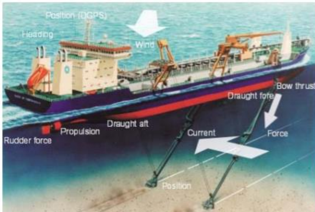
Figura 14. Dragas de succión en marcha, (USACE, 2015).
