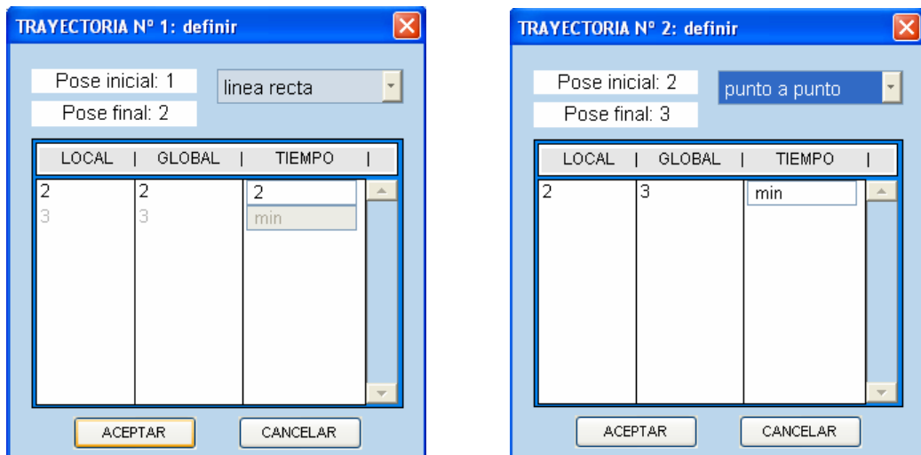
Figura A.49. Asignación de las trayectorias, a) línea recta con T = 2 segundos, b) punto a punto con T = T_{\text{mínimo}} .
