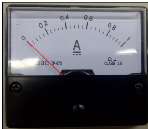
Figura 18. Medidor De Corriente DC Fuente: "Autor"
