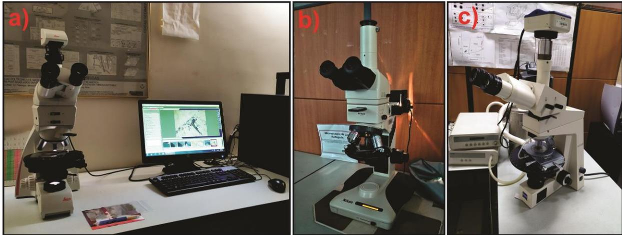
*Nota:* **a)** Microscopio de luz transmitida Leica DM750P; **b)** Microscopio de luz reflejada Nikon; **c)** Microscopio ZEISS adaptado con platina de enfriamiento – calentamiento THMS 600 marca LINKAM usado para el estudio microtermométrico de inclusiones fluidas.
