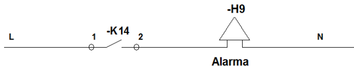
Figura 137. Esquema de accionamiento de la alarma.
