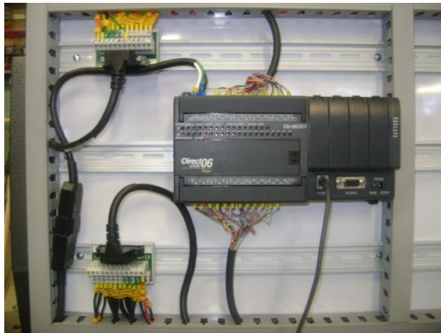
Figura 113. Conexiones del PLC.
