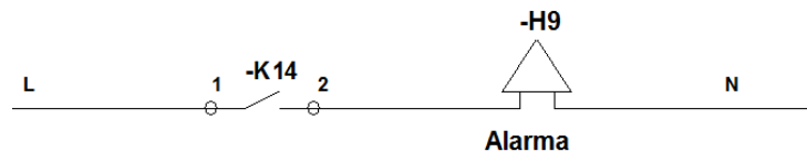
Figura 130. Esquema de accionamiento de la alarma.
