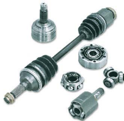
Figura 8. Ejes Homocinéticos Y Sus Componentes
