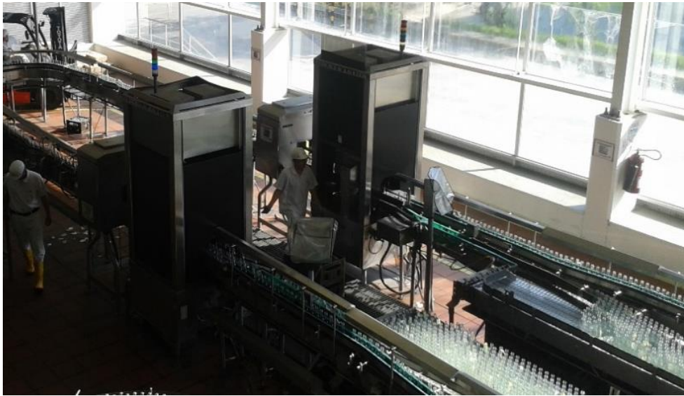
Figura 9. Inspector de botellas vacías. Adaptado del Área de Embotellado de Bavaria Bucaramanga
