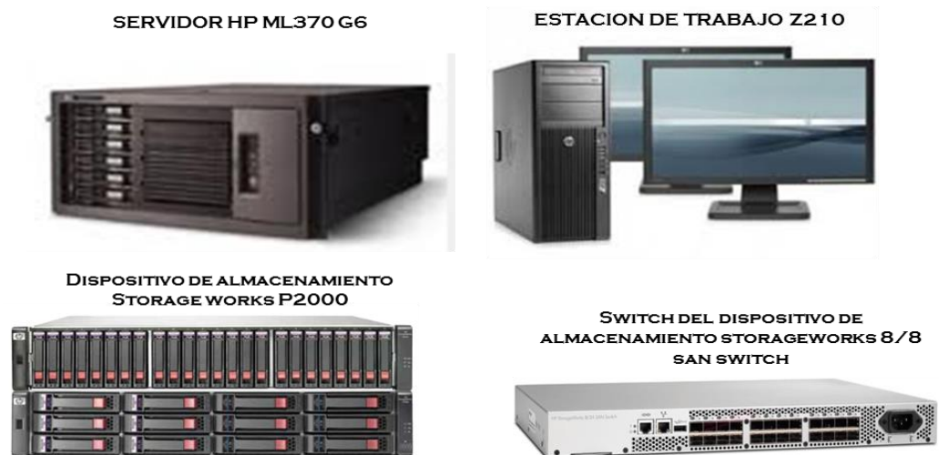
Figura 12. Referencias de hardware del sistema SCADA
