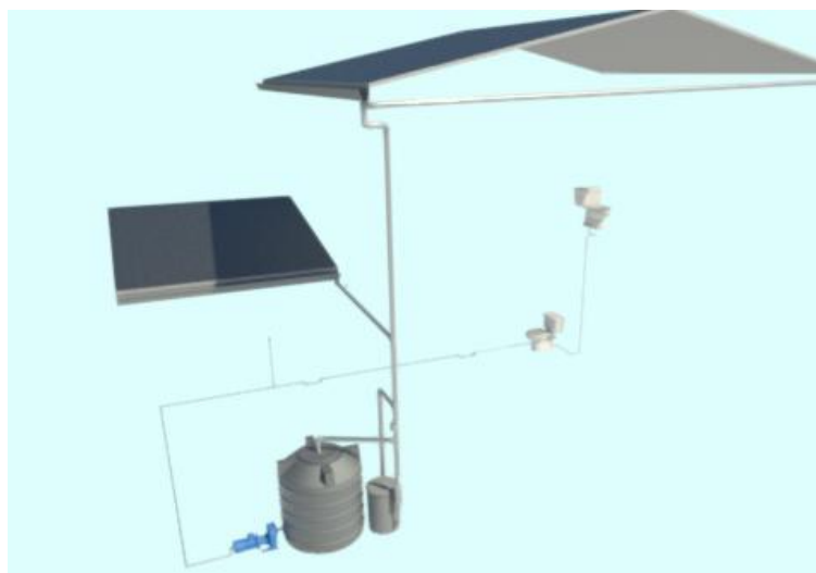
Figura 5. Modelo del sistema de captación de agua lluvia
