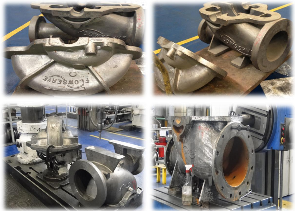
Figura 9. Fundición y mecanizado de carcasas LR
