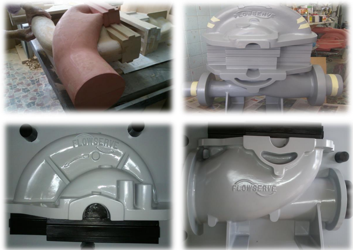
Figura 8. Modelos de fundición en madera para bombas LR
