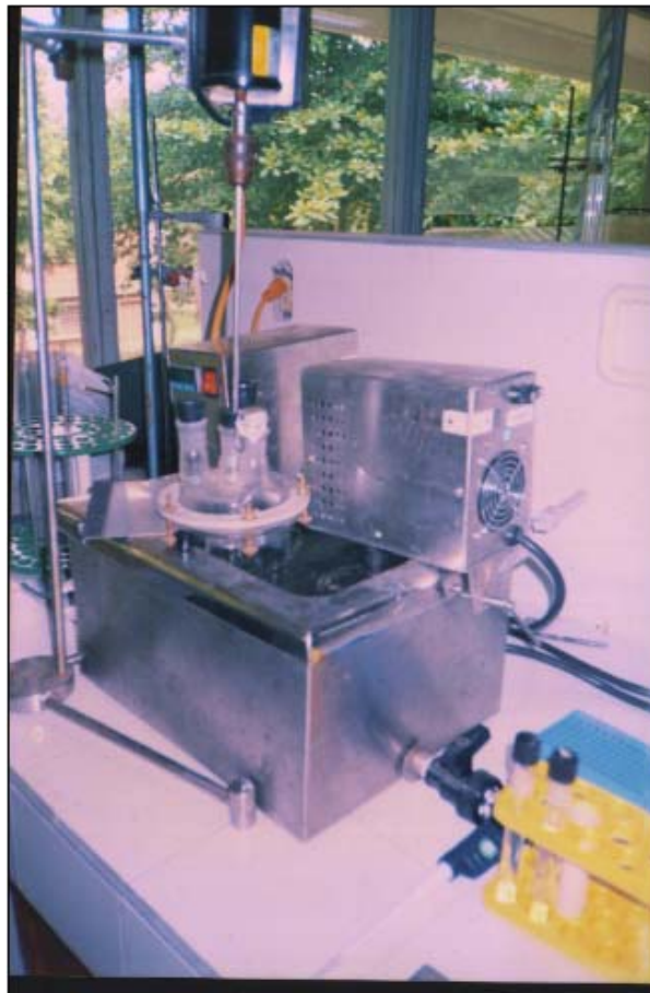
Figura 11. Reactor para Gelificación, Licuefacción y Sacarificación de almidón.
