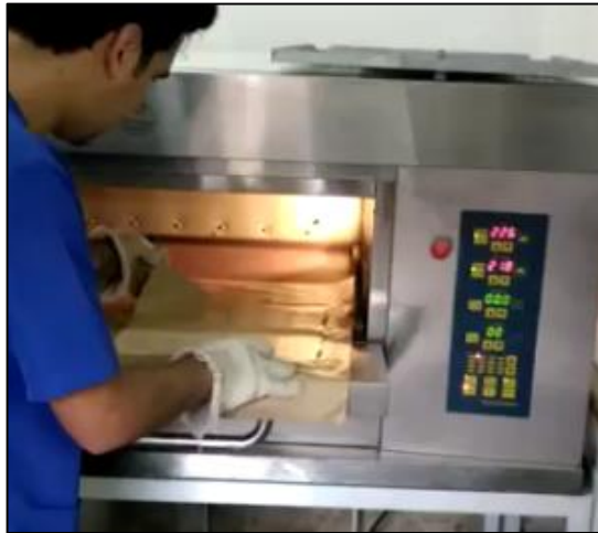
Figura 98. Calentamiento de la lámina de polipropileno.
