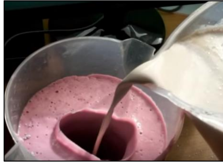
Figura 33. Vertimiento de yeso dentro de la cavidad del molde.
