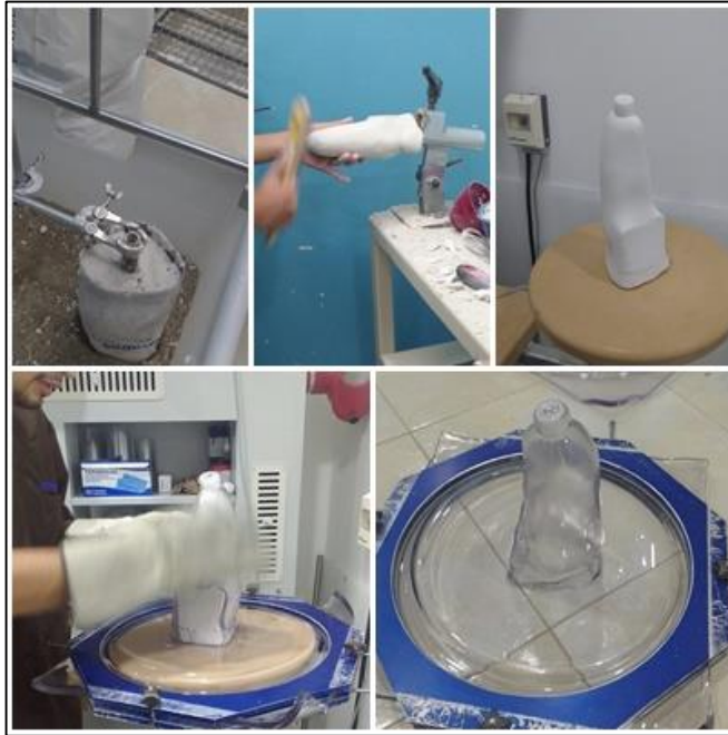
Figura 91. Proceso de plastificado de socket.
