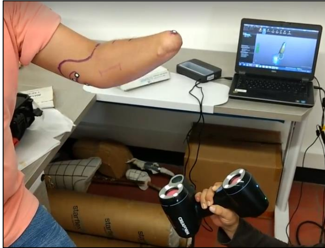
Figura 87. Proceso de escáner 3D, con escáner GoScan Creaform.
