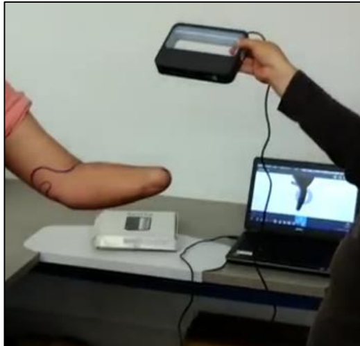
Figura 88. Proceso de escáner 3D, con escáner Sense scan.
