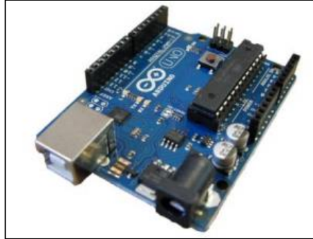
Figura 9. Arduino UNO con microcontrolador en formato DIP.
