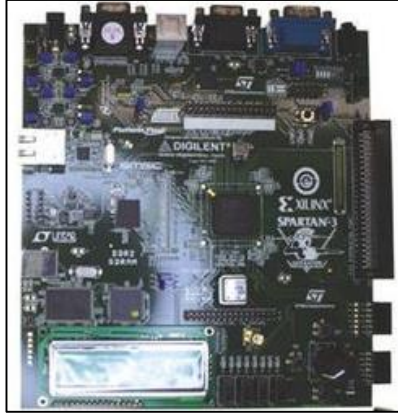
Figura 8. Kit de desarrollo, HW-SPARTAN3AN-SK-UNI-G, FPGA.
