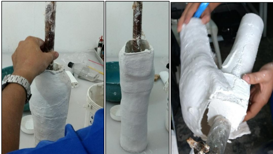
Figura 97. Conformado del molde del socket externo.
