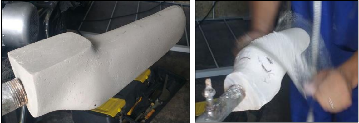
Figura 96. Molde y Termoformado del socket interno.
