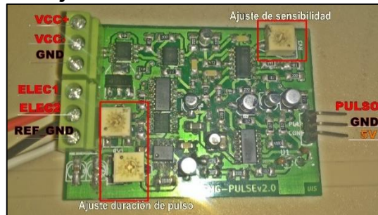
Figura 111. Montaje en tarjeta PCB. Convertidor de la señal EMG a pulsos
