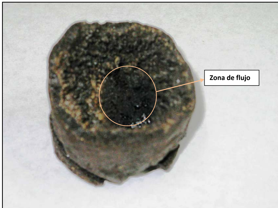
Figura 1. Tapón de asfáltenos recuperado de tubería de producción.
